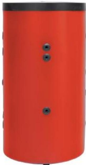
Bollitore per la produzione di acqua calda sanitaria, con serpentino doppio serpentino, completo di coibentazione in poliuretano ad alta densità e di forte spessore, rivestimento esterno in PVC, anodo di magnesio per la protezione da correnti galvaniche, flangia di ispezione e valvola di sicurezza.
