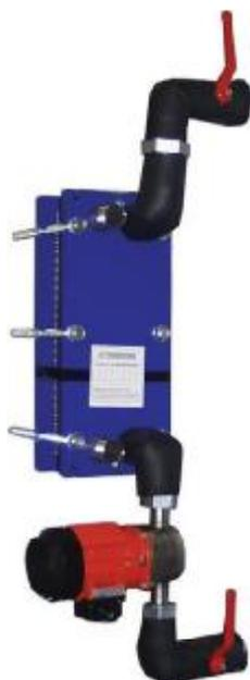
Kit da accoppiare ad accumuli della serie TK e TKX per trasformarli in AFK e AFKX; sono composti da scambiatore saldobrasato K042, pompa di ricircolo sul lato sanitario, valvole di intercettazione, raccorderia e termostato per circuito primario.
