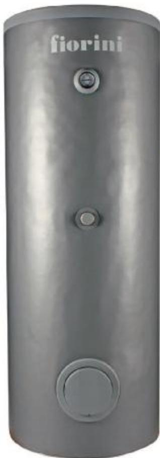
Bollitore per la produzione di acqua calda sanitaria, con doppio serpentino fisso, completo di coibentazione in poliuretano rigido ad alta densità e di forte spessore, rivestimento esterno in PVC di colore metal, anodo di magnesio per la protezione da correnti galvaniche, flangia di ispezione e valvola di sicurezza.
